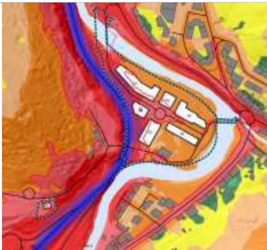
Figura 23. Superficie afectada por la isófono de 60 dB (A) (línea roja, uso del suelo residencial), a 2 metros sobre el terreno, correspondiente al periodo día (Ld). Resultado sin pantallas.
