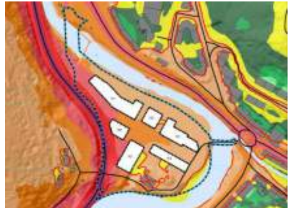
Figura 8. Superficie afectada por la isófona de 50 dB (A) (línea roja, uso del suelo residencial) a 2 metros sobre el terreno, correspondiente al periodo noche (Ln). Alternativa 2 (elegida).
