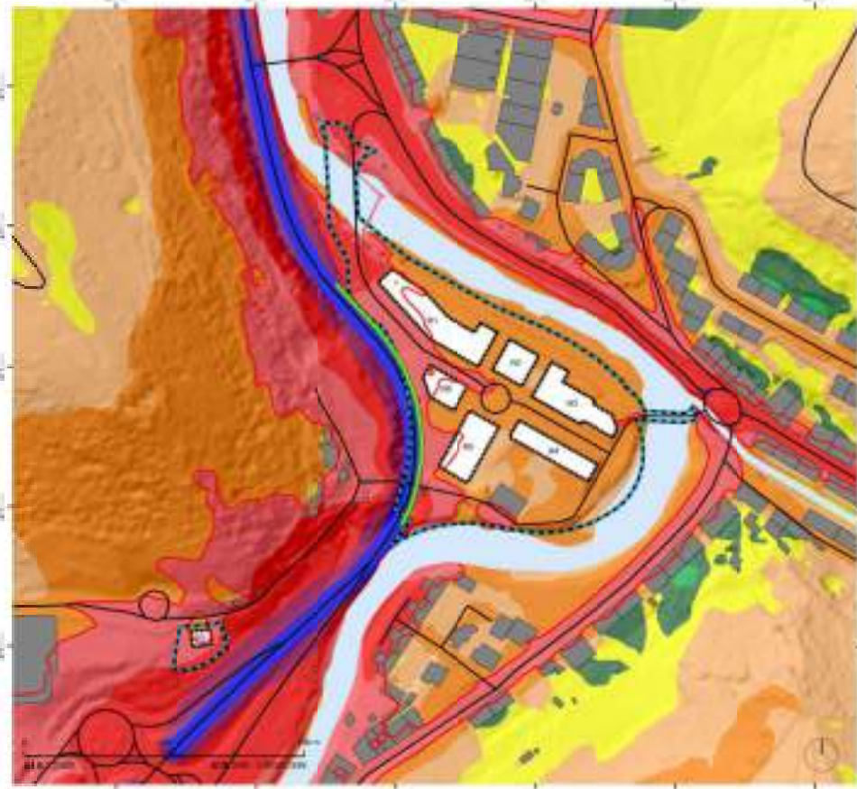
MAPA DE NIVELES SONOROS A 2 METROS DE ALTURA. ESCENARIO: FUTURO CON MEDIDAS CORRECTORAS PERIODO DE EVALUACIÓN: DIA
