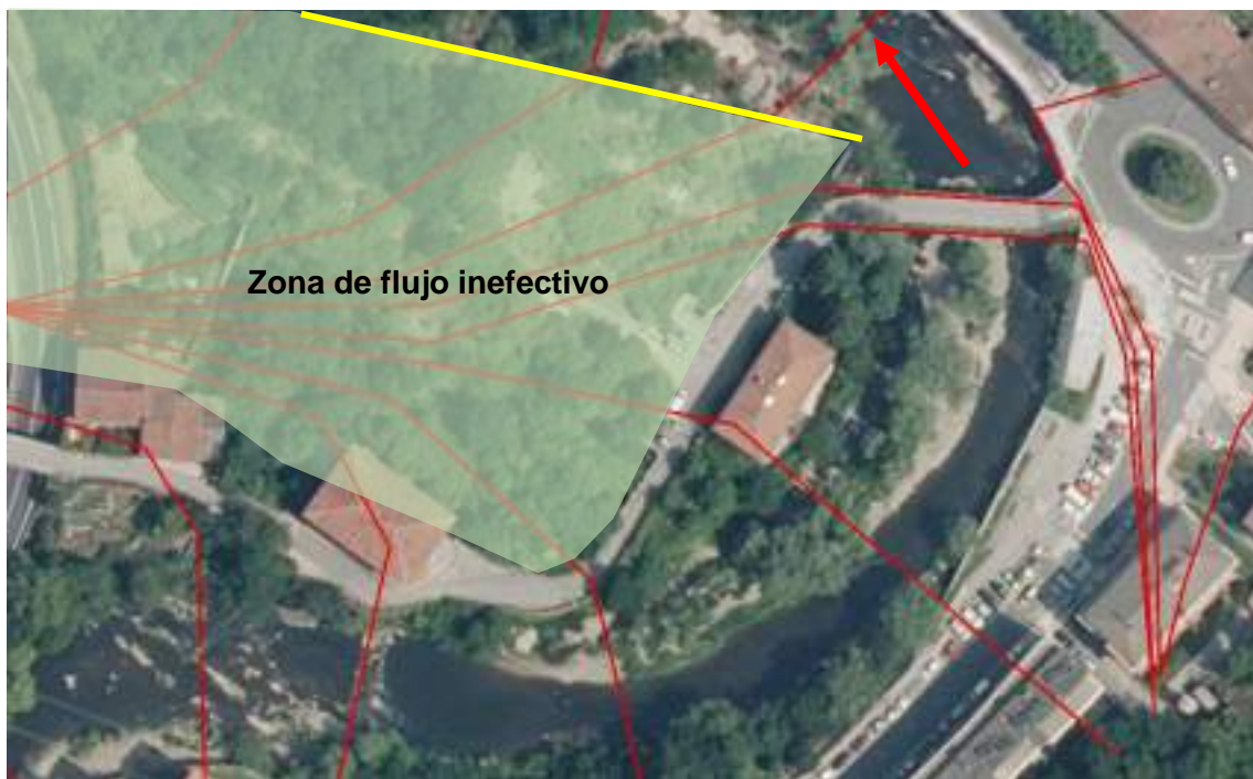
Ilustración 18. Zona de flujo inefectivo generado por el muro de cierre de Algodonera.
