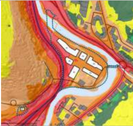
Figura 25. Superficie afectada por la isófono de 60 dB (A) (línea roja, uso del suelo residencial) a 2 metros sobre el terreno, correspondiente al periodo tarde (Le). Resultado sin pantallas.
