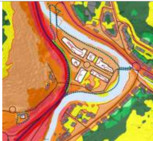
Figura 28. Superficie afectada por la isófono de 50 dB (A) (línea roja, uso del suelo residencial) a 2 metros sobre el terreno, correspondiente al periodo noche (Ln). Solución con pantallas (en verde).
