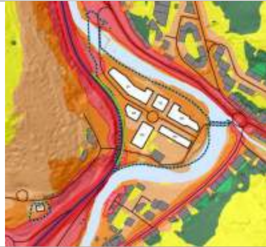
Figura 26. Superficie afectada por la isófono de 60 dB (A) (línea roja, uso del suelo residencial) a 2 metros sobre el terreno, correspondiente al periodo tarde (Le). Solución con pantallas (en verde).
