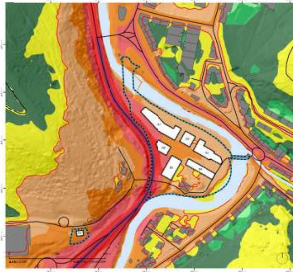
MAPA DE NIVELES SONOROS A 2 METROS DE ALTURA. ESCENARIO: FUTURO PERIODO DE EVALUACIÓN: TARDE
