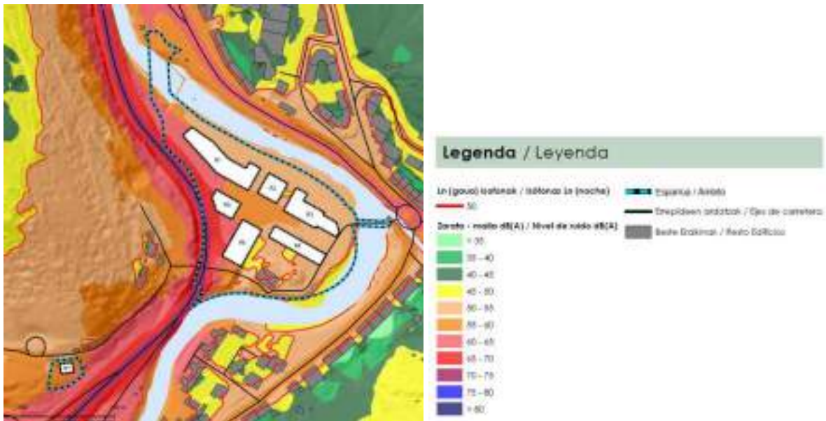
Figura 16. Imagen parcial del plano 2.3.2. Mapa de Ruido. Situación futura Ln (noche), 2m.
