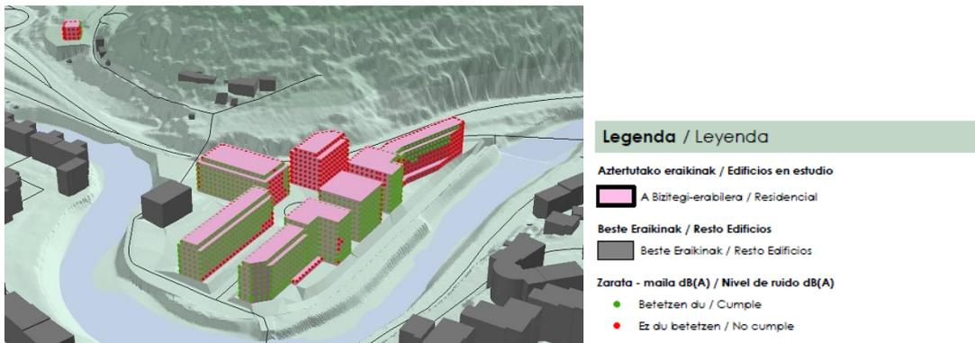
Figura 22. Vista 2 con niveles de ruido en fachadas para el periodo noche (Ln).
