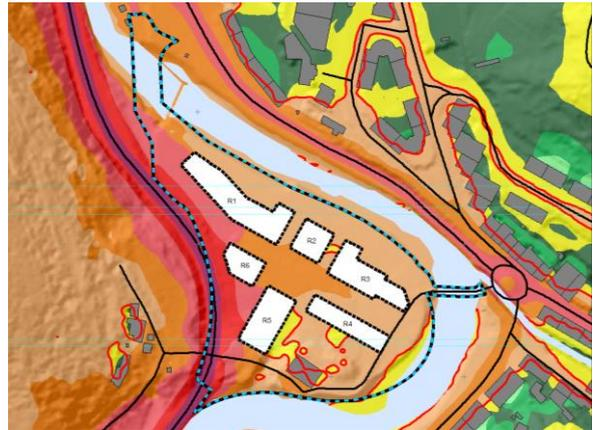
Figura 8. Superficie afectada por la isófona de 50 dB (A) (línea roja, uso del suelo residencial) a 2 metros sobre el terreno, correspondiente al periodo noche (Ln). Alternativa 2 (elegida).
